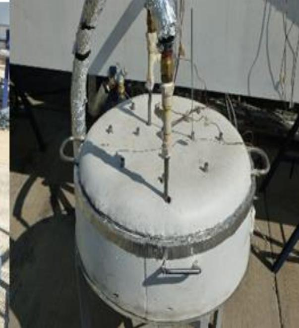
Evaporadora con capacidad de 35 l. Aislante térmico y perforaciones en la tapa para permitir la salida de vapor
